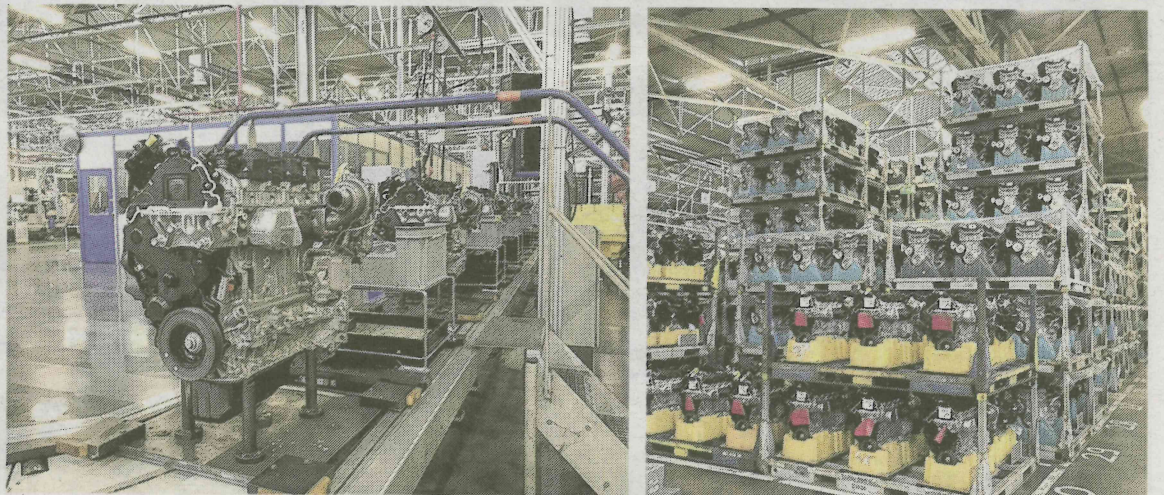
Vincent Beauchot devant les bacs de « kitting », amenés automatiquement au bord de la chaîne de montage. Objectif de cette innovation : multiplier par 4 ou 5, d'ici septembre, le nombre de moteurs produits par jour.
