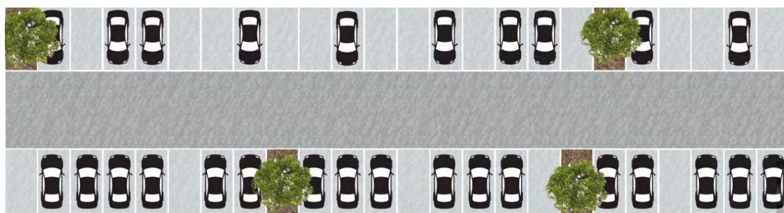
Contre-exemple : Intervalle entre 2 arbres plantés non conforme et ratio de plantation non respecté.
