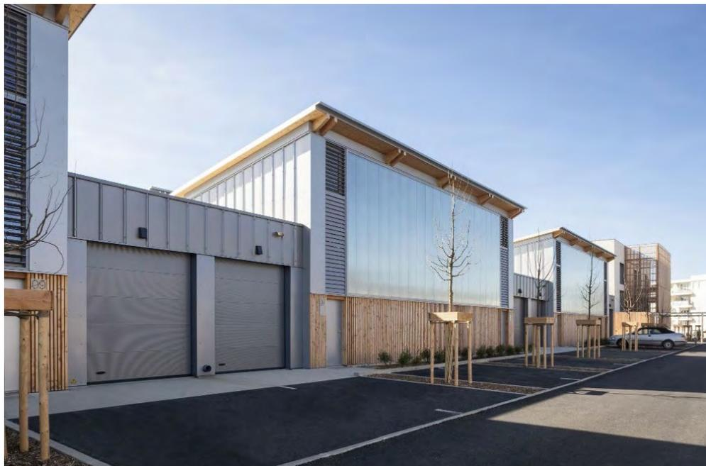
Exemple de bardages bois et panneaux polycarbonate
